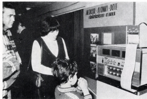
Vonalíró rögzíti a kilélegzett levegő összetételét, amely a szervezet anyagcseréjére jellemző fontos adat. (A fényképeket Nagy István ATOMKI készítette)
