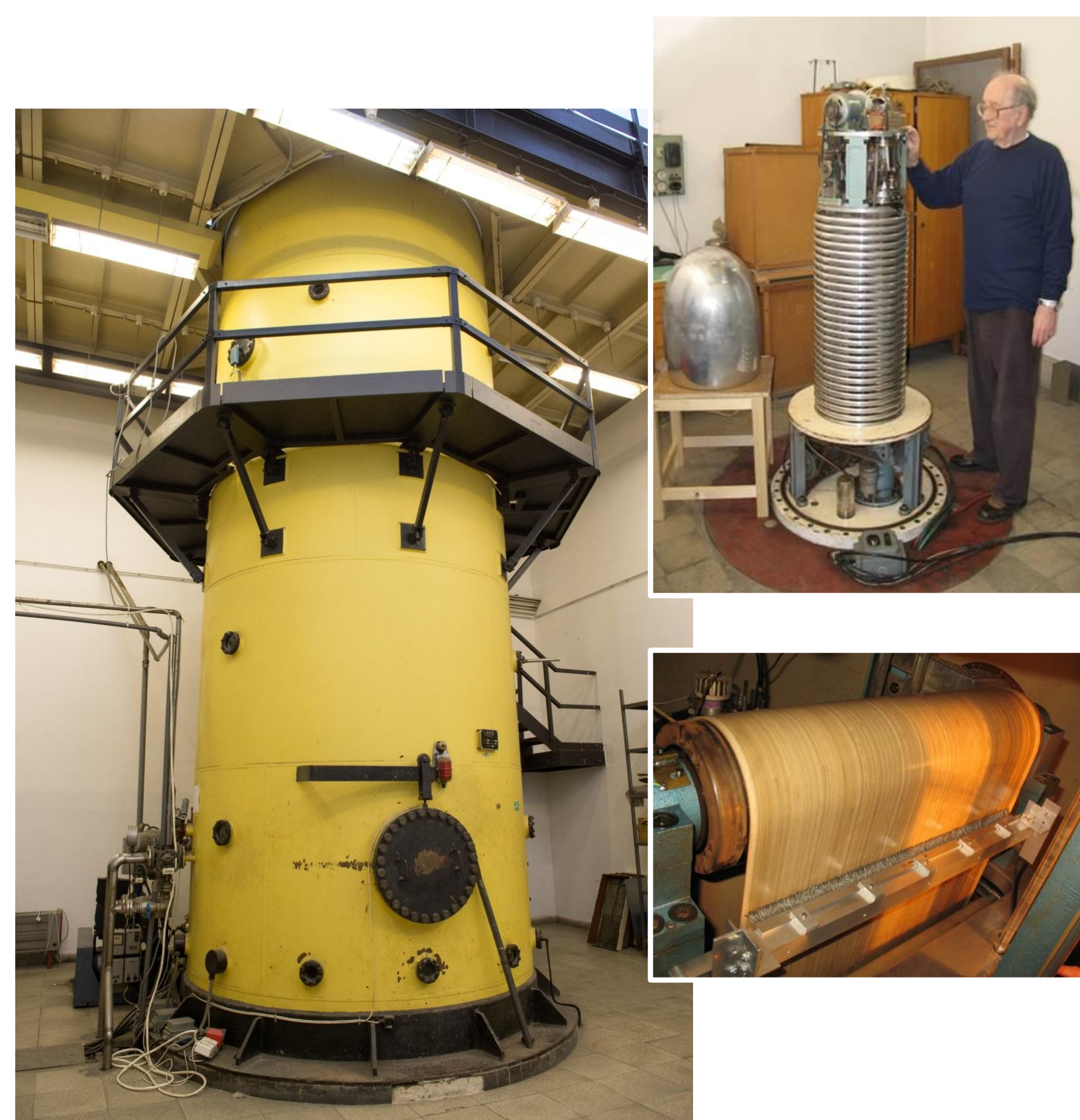
5 millió voltos VdG-5 generátor; a mai napig a legkihasználtabb gyorsítónk
