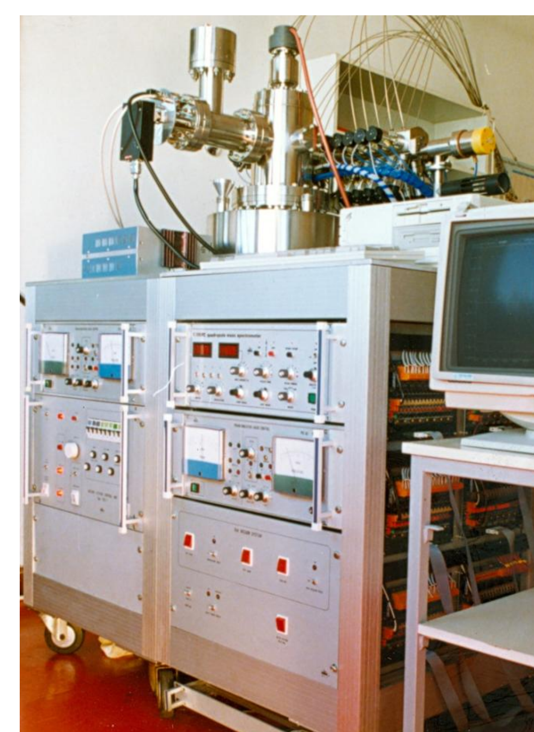
20 mintavevős PC-vezérelt KTS-rendszer és talajmérés az MTA TAKI-ban
