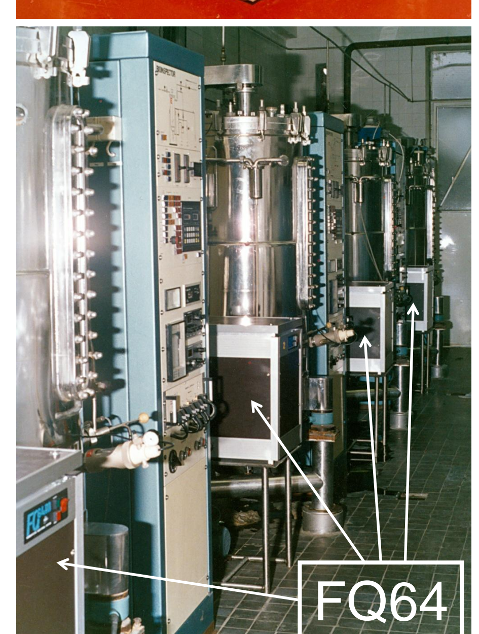
20 mintavevős PC-vezérelt KTS-rendszer és talajmérés az MTA TAKI-ban
