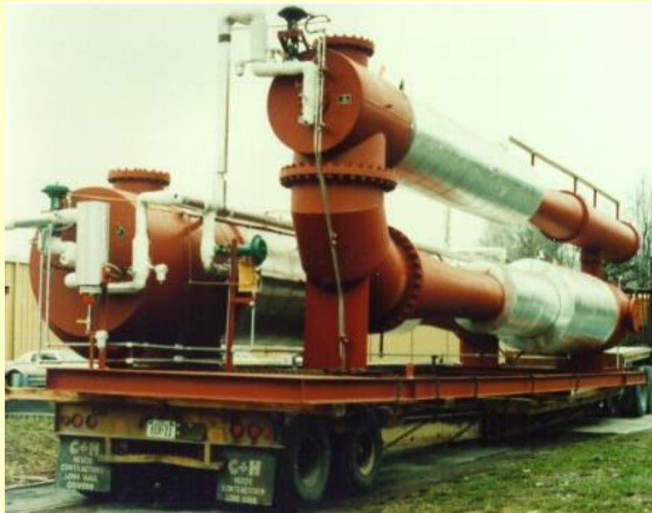
9.2.3. ábra. Egy acélüzem 3 ejektoros fúvókás szivattyúja. Végvákuuma: \leq 5 \cdot 10^{-2} mbar [G1].
