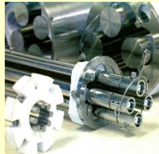
7.4.1. ábra. A kvadrupól tömegspektrométer analízátorának elvi rajza és fényképe.
