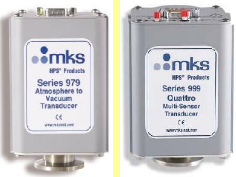
6.5.2.7. ábra. Egy kombinált ionizációs – szilárdtest Pirani és egy kombinált ionizációs – szilárdtest Pirani – piezoellenállásos mérőfej fényképe [MKS1]. 10 -10 mbar-tól atmoszféráig mérnek.
